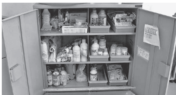
改善例①漏洩対策として、液剤の下にバットを置いた例
