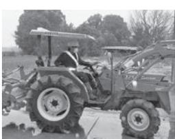
写真 トラクタ使用時の服装例(ヘルメット、反射ベストを着用)
